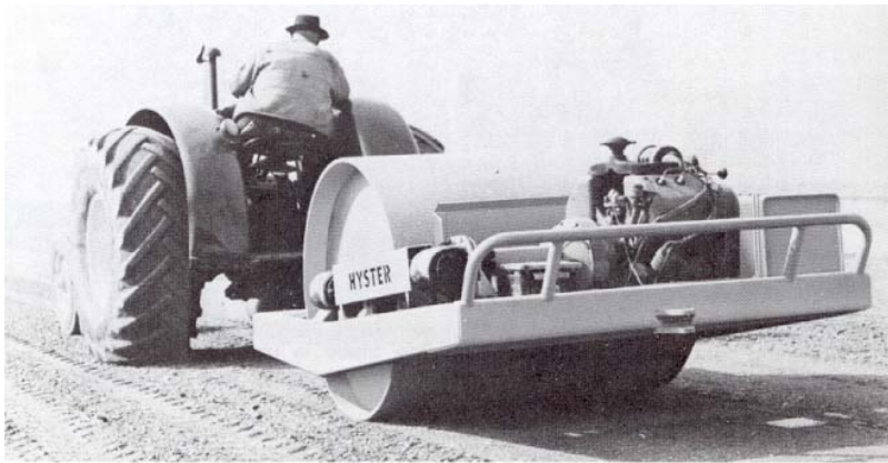
Figura 2.6 – Rullo compressore (vibratore) usato per terreni granulari
