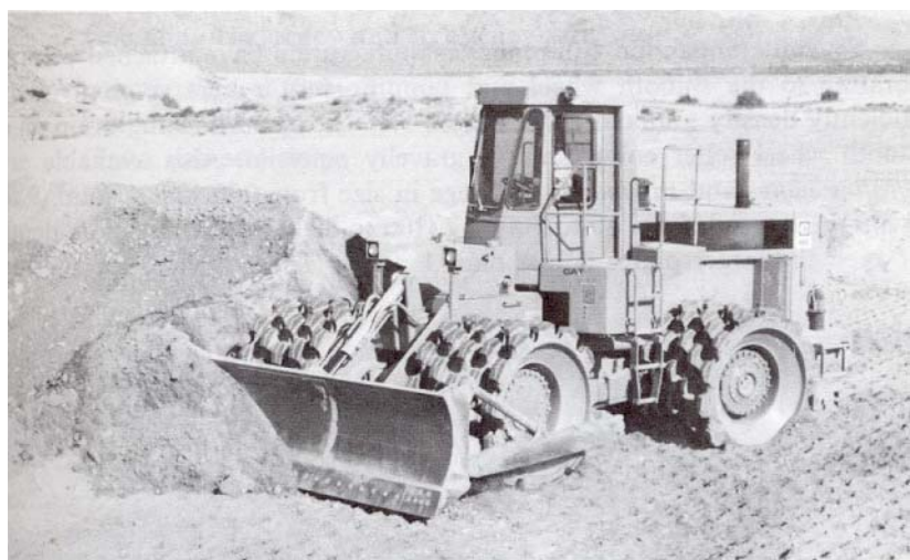
Figura 2.5 – Rullo compressore usato per terreni a grana fine
